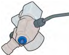
manueller Absperrhahn am Fuß des Flaschenventils.
