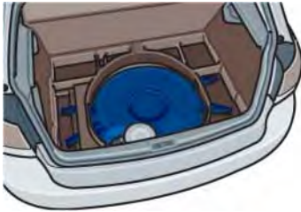
Der Flüssiggastank in der Reserveradmulde
