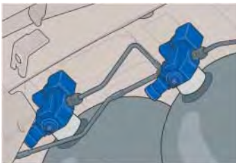
elektromagnetische Absperrventile an den Gastanks
