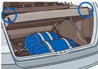
die Gastanks unter dem Ladeboden
