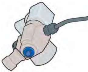
manueller Absperrhahn am Fuß des Flaschenventils.
