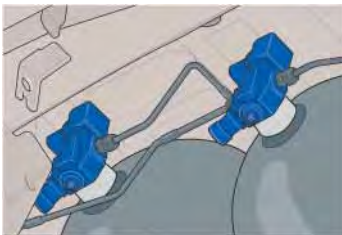
elektromagnetische Absperrventile an den Gastanks
