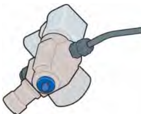
manueller Absperrhahn am Fuß des Flaschenventils.
